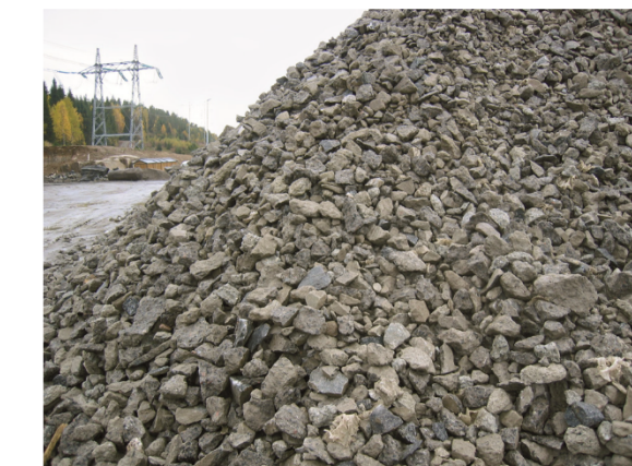
Fig. 11 Resirkulert tilslag av knust betong. Foto: SINTEF Byggforsk
