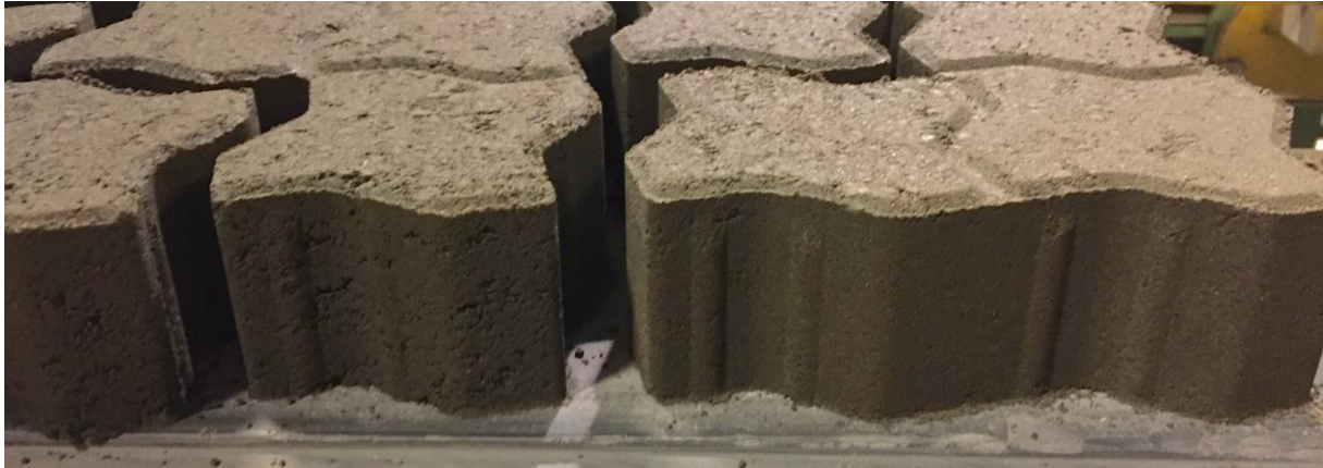
Figur 13.17 Belegningssteinen til venstre er produsert med ASAKs resept. Belegningssteinen til høyre er produsert med resept 4. Bildet er tatt rett etter avforming [eget bilde]
